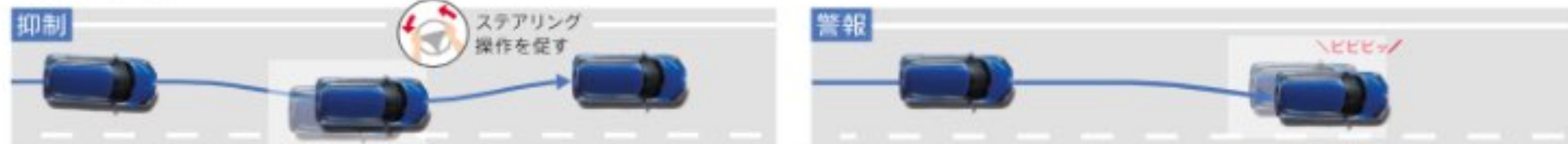
●ドライバーの緊急操舵時は、ドライバーの操舵を妨げません。●ウィンカーが出ている間は、車線変更の意図があると判断し、車線逸脱抑制機能および車線逸脱警報機能を一旦停止します。
