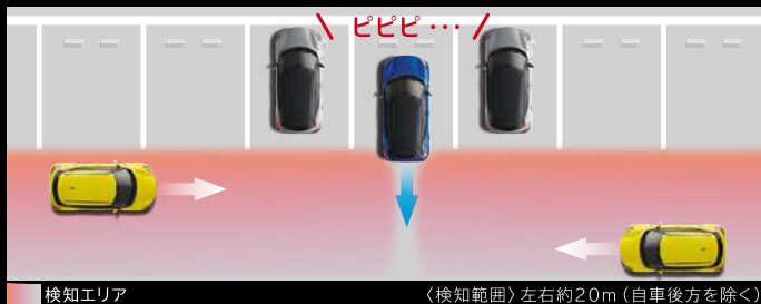
検知エリア 〈検知範囲〉左右約20m（自車後方を除く）
