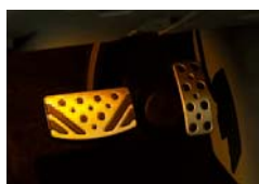
フットランプ （フロント／セカンド、LEDタイプ） 室内の上質な演出と、夜間の乗降をサポートします。
