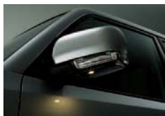
電動格納式リモコンドアミラー （ヒーター／ウインカー／アプローチランプ付） アプローチランプは夜間の乗降時に足元を照らします。 〈SUPER EXCEED、EXCEED、VR-IIに標準装備。GR、VR-Iにパッケージメーカーオプション〉
