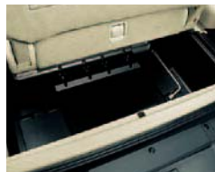
ラゲッジフロアボックス サードシートやジャッキなどの工具類を収納。
