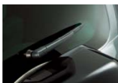
開欠ワイパー （リヤ） 小雨時に便利な開欠式。リバース時に運動します。
