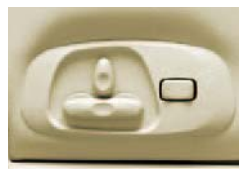
パワーシート （運転席） スライド、リクライニングの電動調節に加えて、運転席はハイト、チルト、ランバーサポートの調節も可能（電動調節）です。 〈運転席 = SUPER EXCEED、VR-IIに標準装備。EXCEEDにパッケージメーカーオプション。助手席 = SUPER EXCEEDに標準装備。EXCEEDにパッケージメーカーオプション〉
