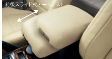
大型フロアコンソール アームレストを開けると、小物用トレイとCDが約14枚入るボックスの2段式です。 ●カップ型灰皿はディーラーオプション
