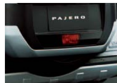
リヤフォグランプ 悪天候などの視界不良時、後続車に注意をうながします。
