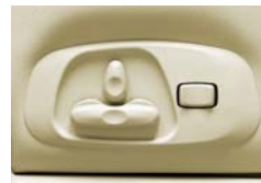
パワーシート （運転席） スライド、リクライニングの電動調節に加えて、運転席はハイト、チルト、ランパサポートの調節も可能（電動調節）です。 〈運転席 = SUPER EXCEED、VR-IIに標準装備。EXCEED にパッケージメーカーオプション。助手席 = SUPER EXCEED に標準装備。EXCEED にパッケージメーカーオプション〉
