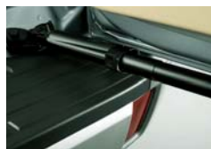
バックドアストッパー （オイルダンパー） 任意の位置でドアを保持。坂道や強風などでの急な閉閉も低減します。
