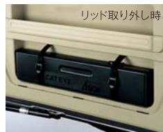
バックドアボックス(リッド付) 上段は収納棚。下段は三角表示板(ディーラーオプション)収納(固定ベルト付)。
