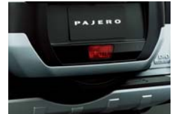
リヤフォグランプ 悪天候などの視界不良時、後続車に注意をうながします。
