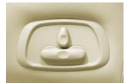
パワーシート （運転席） スライド、リクライニングの電動調節に加えて、運転席はハイト、チルト、ランパサポートの調節も可能（電動調節）です。 〈運転席 = SUPER EXCEED、VR-IIに標準装備。EXCEED にパッケージメーカーオプション。助手席 = SUPER EXCEED に標準装備。EXCEED にパッケージメーカーオプション〉
