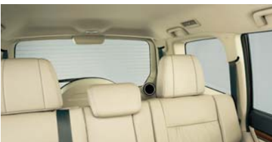
後方視界を妨げない後席L字型センターヘッドレスト。 （写真はサードシート収納時）
