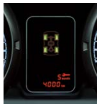
定期点検時期を表示するサービスリマインダー。（表示例）
