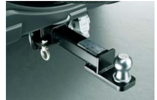
トレーラーヒッチメンバー(最大牽引荷重 750kg)
