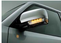
電動格納式リモコンアミラー （ヒーター／ウインカー／アプローチランプ付） アプローチランプは夜間の乗降時に足元を照らします。 〈SUPER EXCEED、EXCEED、VR-IIに標準装備。GR、VR-Iにパッケージメーカーオプション〉
