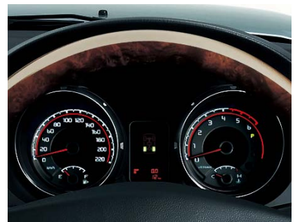
ハイコントラストメーター（常時照明明点灯・レオスタート付）
