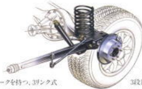
リアトリプルリンクコイルスプリングサスペンション
