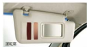
16 サンバイザー(バニティミラー(運転席/助手席)&チケットホルダー(運転席))
