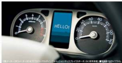
2眼メーター(計速メーター・回転メーター) | 12.1インチTFTカラーマルチインフォメーションディスプレイ(Gターボ、Gに標準装備) | 専用液晶ディスプレイ、専用液晶モニター
