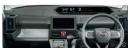
サイドレジスタターペゼム、インパネアッパー・ボックス(運転席)追加、大型インパネトレイ (助手席)と上部装飾はネイビー、センターレジスタターペゼムは装着オプションとなります。
