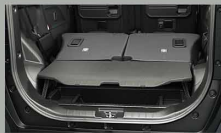
リヤシートバック・デッキボード(上段モード:耐荷重20kg)フラット状態
