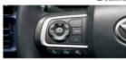
ステアリングスイッチ(パノラマモニター及び 駐車支援用)
