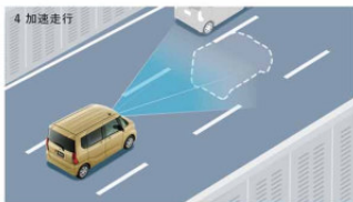
設定した速度より車速が遅い車がいなくなると、設定速度まで加速し、定速走行へ移行します。
