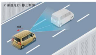
先行車を認識した場合は、先行車の車速に合わせて減速し、先行車が停止すると、先行車に続いて停止します。(停止保持時間は最長約3分間)
