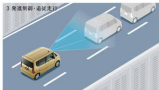
先行車が発進している状態で“+RES”スイッチを押す、またはアクセルを踏むと、追従走行に戻ります。
