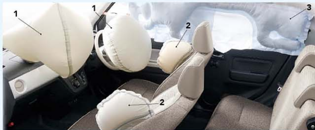
1. デュアルSRSエアバッグ 2. SRSサイドエアバッグ(運転席/助手席) 3. SRSカーテンシールドエアバッグ(前後席)
