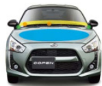
樹脂ボンネットフード ワイパーピボット ヒンジ カウル
