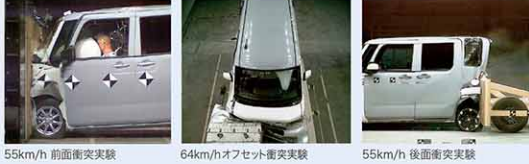
55km/h 前面衝突実験
