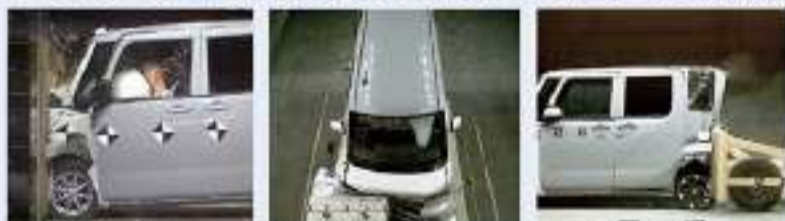
55km/h 前面衝突実験
