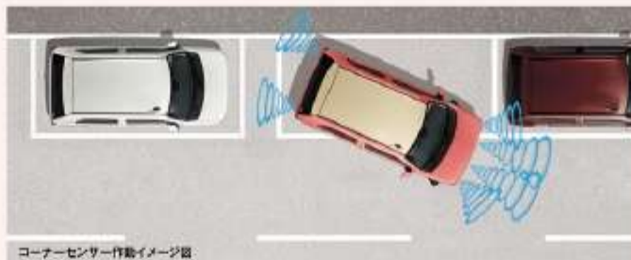
コーナーセンサー作動イメージ図
