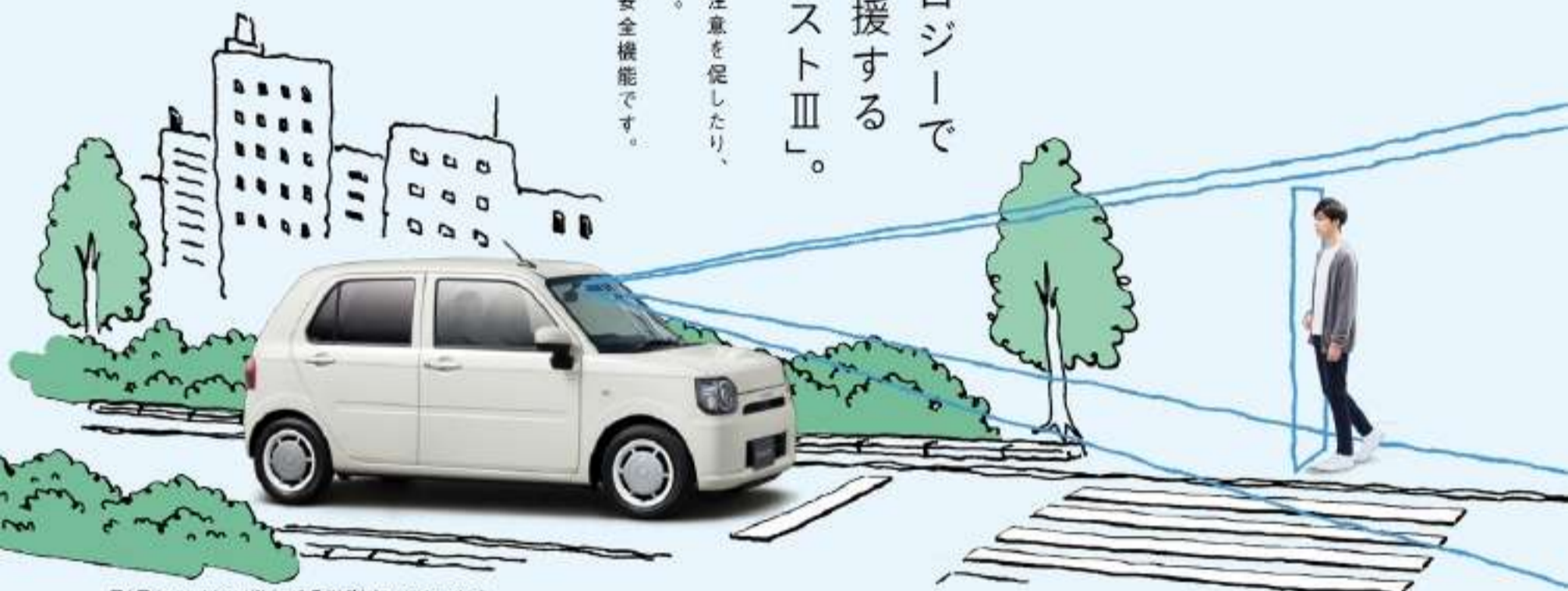
■上図はステレオカメラが前方の歩行者を検知しているイメージです。
