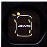
舵角モニター タイヤの切れ角がひと目でわかるモニター。 メーターパネル内に装備しました。
