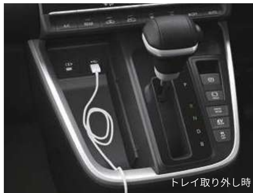
①シフト横小物入れ〈充電用USB端子 (Type-C) 1個、通信/充電用USB端子 (Type-A) 1個付〉*1
