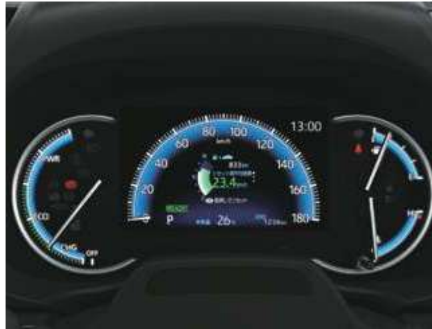
オプティロンメーター+7.0インチTFT カラーマルチインフォメーションディスプレイ [S-Z、Zに標準装備（写真はハイブリッド車）]
