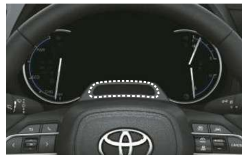
ドライバーモニターカメラ ■ドライバーモニターカメラで運転者の顔の位置・向きや眼の開閉状態を検知。運転者が周囲の状況を確認し運転操作できる状態であるかシステムが判断し、ブザーとディスプレイ表示で注意喚起を行います。*3
