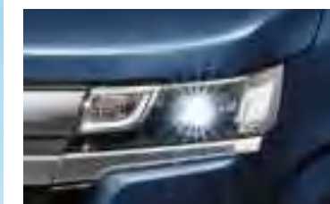
LEDヘッドランプ [ハイ/ロービーム、オートレベリング機構付] (HYBRID ZX, HYBRID ZT) ※1
