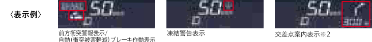
<表示例> 前方衝突警報表示/自動(衝突被害軽減)ブレーキ作動表示 凍結警告表示 交差点案内表示※2
