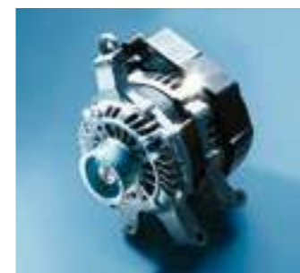
ISG(モーター機能付発電機) 発電効率を高め、減速エネルギーを利用して効率よく発電。モーター機能をあわせ持ち、アイドリングストップからのエンジン再始動や加速時にモーターでエンジンをアシストします。 *ISG=Integrated Starter Generator
