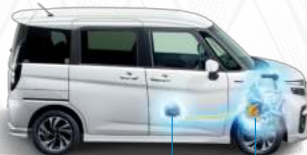
リチウムイオンバッテリー ISG(モーター機能付発電機) *写真はマイルドハイブリッドのイメージです。 *ISG=Integrated Starter Generator
