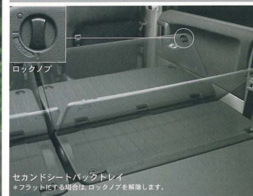
ロックノブ セカンドシートバックトレイ *フラットにする場合は、ロックノブを解除します。
