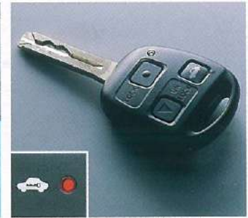
⑫マルチファンクションワイヤレスドアロック リモートコントロール(アンサーバック機能付) 施錠・解錠の確認にハザードランプを点滅させるアンサーバック機能を採用。さらにアラーム&エンジンモビライザーを組み込んだ盗難防止システムも装備しました。
