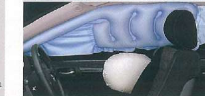
■写真は機能説明のためにSRSエアバッグが作動した状態を再現したものです。なお、SRSサイドエアバッグ、SRSカーテンシールドエアバッグは、実際の衝突時には衝突角のみ影響します。
