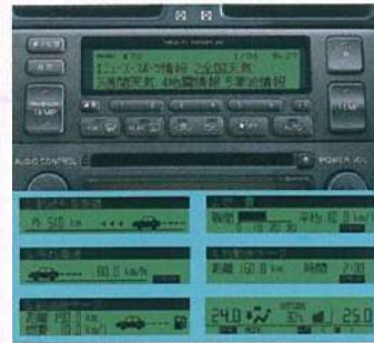
⑪FM文字多重放送対応マルチディスプレイ 天気予報、交通情報などの情報が得られるFM文字多重放送のほか、燃費、走行距離をはじめとする「クルーズインフォメーション」や「車両オーナーニング」も表示されます。 *安全のためFM文字多重放送は走行中表示されません。画面はハメ込み合成です。
