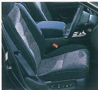
⑬マルチアジャスタブルパワーシート 運転席8ウェイ、助手席4ウェイのアジャスト機構を備え、つねに最適な着座ポジションが得られます。
