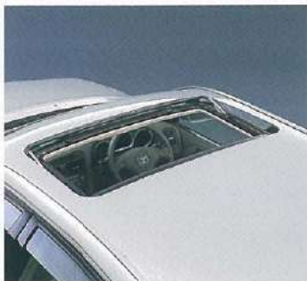
⑤チルト&スライド電動サンルーフ(挟み込み防止機能付) ワンタッチで爽快なクルーズングがたのしめます。チルトアップ機構により、室内の換気性能にも優れています。
