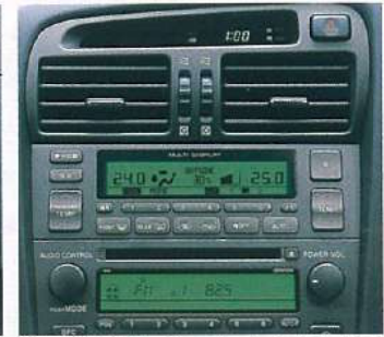
⑯左右独立温度コントロールマイコンオートエアコン 運転席側・助手席側でそれぞれ独自の温度設定が可能。またセンサーからの日射量情報をもとに、きめ細かな室温のコントロールを行います。 *画面はハメ込み合成です。
