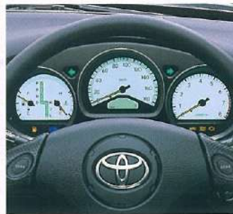
⑩オプティトロンメーター 独立3眼式ホワイトフェイス。文字盤面を発光させ、文字や指針、目盛をシルエット表示します。直射日光下での視認性にも優れています。 *写真の計器盤は機能説明のため各ランプを点灯させたものです。
