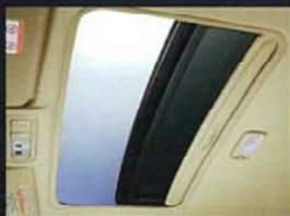
マイコン制御ハンドル&スライド電動式ムーンルーフ (ワンタッチ開閉、ロック込み禁止機構付) ムーンルーフをワンタッチ操作で閉じている間に、障害物などを感知すると再び閉まるのを防ぐロック機構です。 *ご使用の際は、必ず取扱説明をご覧ください。
