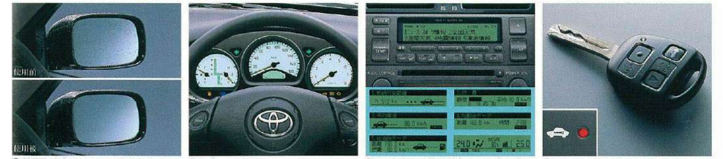
⑧マルチアジャスタブルパワーシート(運転席8ウェイ・助手席4ウェイ)電動ランバーサポート(運転席)前後上下調整式フロントヘッドレスト前後上下調整式リヤヘッドレスト(中央席は上下調整式)前席ELR付3点式シートベルト(電気式デレクションリデューサー・プリテンションャー&フォースリミッター機能付)後席ELR付3点式シートベルト(電気式デレクションリデューサー付<左右席>/チャイルドシート固定機構付) ⑨オプティクロンメーター独立3眼式ホワイトフェイス。文字画面を発光させ、文字や指針、目盛をシルエット表示します。直射日光下での視認性に優れています。直視日光で、内蔵されたヒーターと曇りに雨天時の視認性確保に貢献します。 ⑩FM文字多重放送対応マルチディスプレイ天気予報、交通情報などの情報が得られるFM文字多重放送のほか、燃費、走行距離をはじめとする「クルーズ下での視認性に優れています。直視日光で、内蔵されたヒーターと曇りに雨天時の視認性確保に貢献します。*写真は計器盤は機能説明のため各ランプを点灯させたものです。
