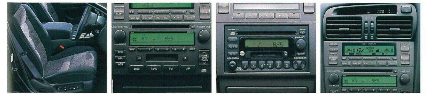
⑪カセット一体AM/FMマルチ電子チューナーラジオ+CDプレーヤー ⑫マルチファンクションワイヤレスドアロックリモートコントロール(アンサーバック機能付)施錠・解錠の確認にハザードランプを点滅させるアンサーバック機能を採用。さらにアラーム&エンジン immobilizerを組み込んだ盗難防止システムも装備しました。画面はハメ込み合成です。 ⑬左右独立温度コントロールマイコンオートエアコン運転席側・助手席側それぞれ独立の温度設定が可能です。またセンサーからの日射量情報をもとに、きめ細かな室温のコントロールを行なっています。*画面はハメ込み合成です。
