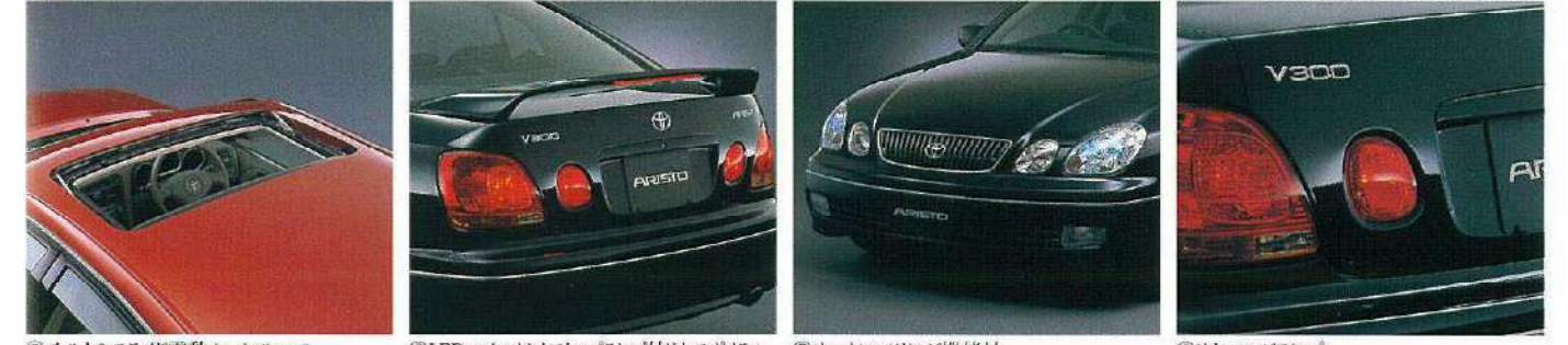
⑤チルト&スライド電動ムーンルーフ(挟み込み防止機能付)ワンタッチで爽やかなクルージングがたのしめます。チルトアップ機構により、室内の換気性能にも優れています。 ⑥LEDハイマウントストップランプ付リヤスポイラーリヤエンドをより格好に見せるリヤスポイラー。制動時に後続車からの被視認性を高めるLEDハイマウントストップランプ付です。 ⑦オートレベリング機能付ディスチャージヘッドランプ(ロービーム)従来のハロゲンヘッドランプに比べて、約70%の消費電力で、より太陽光に近い色と約2倍もの明るさ、そしてワイド照射範囲で夜間走行時の視認性を高めます。
