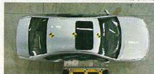
側面衝突実験(50km/h。写真は実験用の試作車です。)
