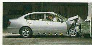
オフセット側面衝突実験(60km/h。写真は実験用の試作車です。)
