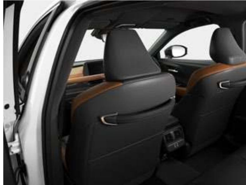
助手席可倒+上下調整式フロントヘッドレスト & 運転席・助手席シートアシストグリップ
