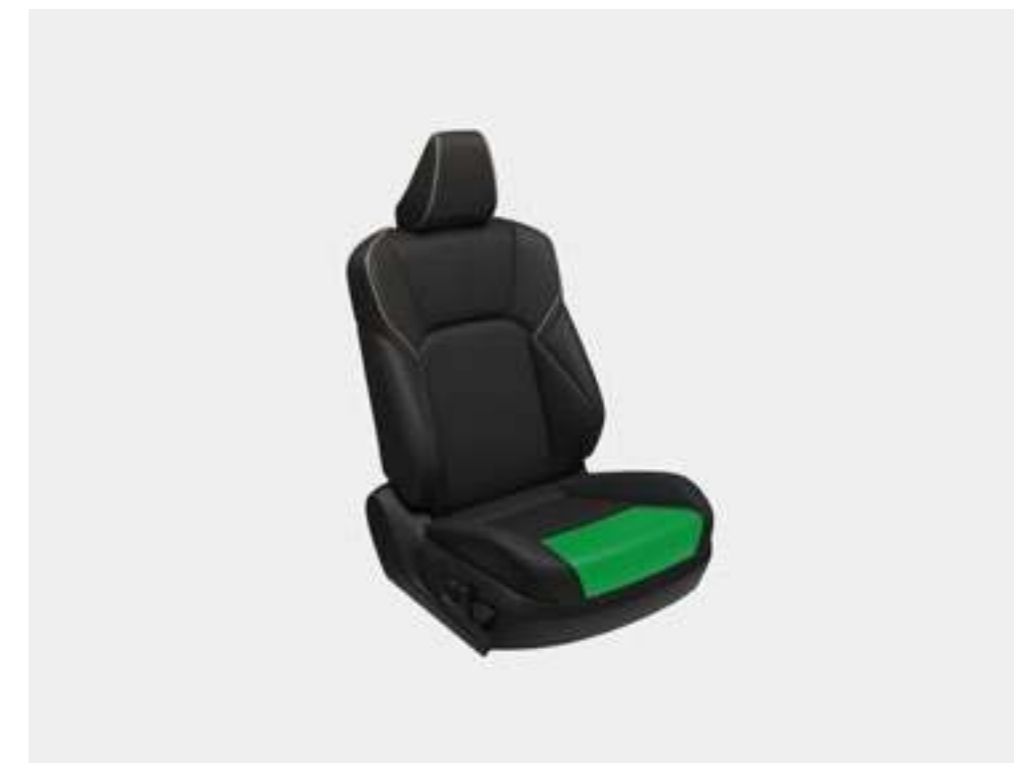
緑は除電スタビライジングプラスシート機能搭載位置。写真は本革シート
