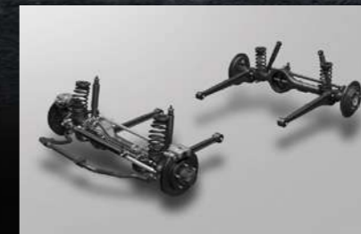
3リンクリジッドアクスル式サスペンション
