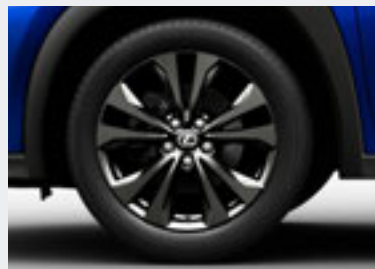
225/50R18ランフラットタイヤ& "F SPORT"専用アルミホイール(ダークプレミアムメタリック塗装)
