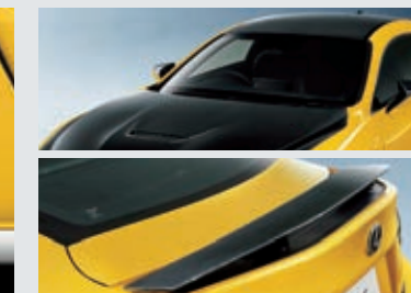
カーボンエクステリアパーツ(エンジンフード・ルーフ) / カーボンアクティブリヤウイング(格納式)
