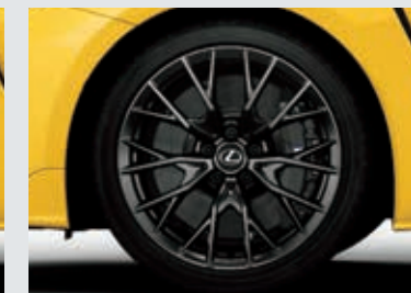
鍛造アルミホイール(BBS製・スーパーグロスブラックメタリック塗装・スパイラル10本スポーク)
