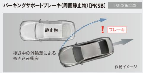
アクセルの踏み間違いや踏みすぎなどで起こる衝突を緩和し、被害の軽減に寄与するシステムです。Lexus Teammate Advanced Park装着車では、静止物の検知対象を前後方のみならず、側方を加えた車両周囲にまで拡大。Advanced Parkのアシスト中だけでなく、出庫や後退中のよう駐車シーンにおいても周囲を監視しながら静止物の接近を表示とブザーで知らせ、さらに距離が縮まるごとに衝突被害軽減ブレーキをかけます。
