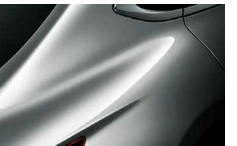
銀影ラスターの実現は、ソニック工法という塗装技術を確立できたことがあります。ソニック工法とは塗料の体積を凝縮し薄い膜にすることにより塗料内のアルミフレークを平滑に並べる技術で、反射をより強く表現することが可能になります。銀影ラスターはこのソニック工法を応用し、塗膜を1ミクロンという極めて薄い層に凝縮する技術を開発。蒸着アルミ粒子を高密度で敷き詰めた究極の金属質感を作り出しました。同時に、塗装技術においても肌感の向上を追求する微粒化と
