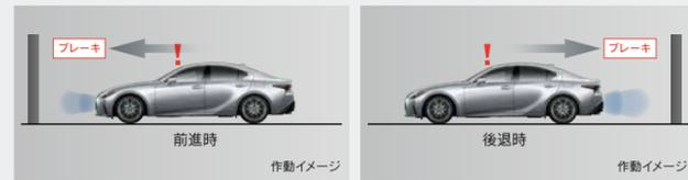
低速走行時に壁などの静止物までの距離と危険度を、マルチインフォメーションディスプレイおよびフロント・リヤブザーなどでお知らせします。低速走行時に壁などの静止物と衝突する可能性が高いと判断した場合、衝突被害軽減ブレーキをかけます。
