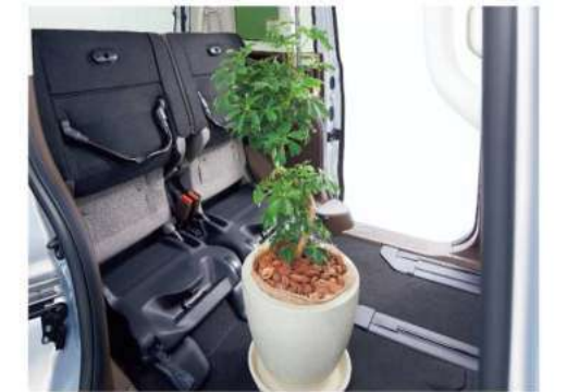
座面をはね上げれば、背の高い荷物もラクラク積載。 後席スペースを荷物が積める空間にできるチップアップ機構。
