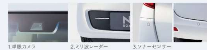
1.単眼カメラ 2.ミリ波レーダー 3.ソナーセンサー ミリ波レーダー、単眼カメラなどを融合した高精度な検知機能で、安心・快適な運転を支援します。
