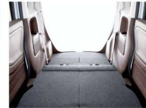
後席の背もたれを前に倒せば、広々空間に。 大きな荷物が積めるダイブダウン機構。
