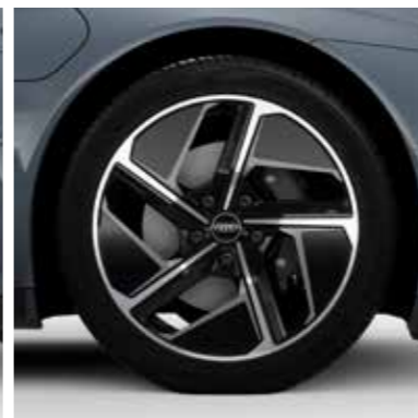
アルミホイール 5スポーク エアロモジュール ブラック フロント9.0J×20+245/45R20タイヤ/ リヤ11.0J×20+285/40R20タイヤ ○Audi e-tron GT quattro ●Audi RS e-tron GT
