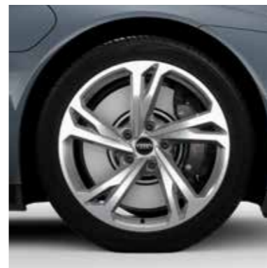
アルミホイール 5ダブルスポークオフセット デザイン プラチナムグレー フロント9.0J×20+245/45R20タイヤ/ リヤ11.0J×20+285/40R20タイヤ ●Audi e-tron GT quattro
