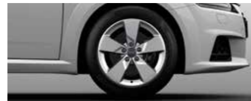
アルミホイール 5アームデザイン 8]×17+225/50R17タイヤ [Audi TT Coupé 40 TFSIに標準装備]
