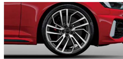
アルミホイール 5セグメントスポークデザイン マットチタングレー 9Jx20+275/30R20タイヤ*
