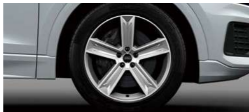
アルミホイール 5アームデザイン 9J×20+275/50R20タイヤ [Audi Q8 55 TFSI quattro, Q8 55 TFSI quattro Luxuryに標準装備]
