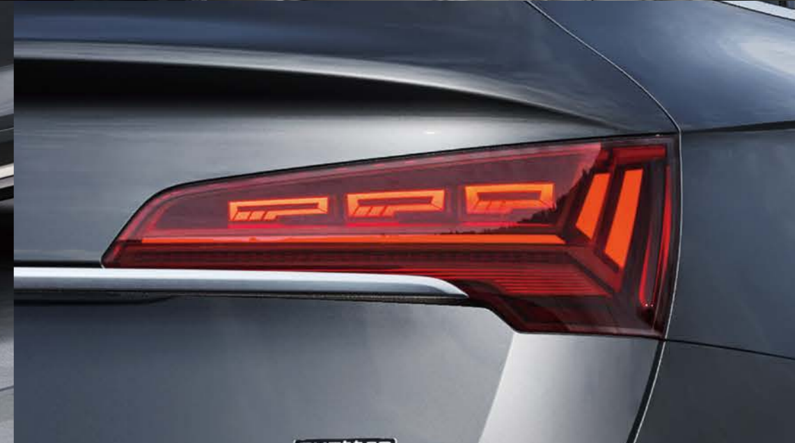
マトリクスOLEDリヤコンビネーションライト/ダイナミックターンインディケーター
