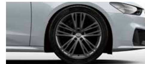
アルミホイール 5ツインスポークVデザイン グラファイトグレー 8.5J×20+255/40R20タイヤ [Audi A7 Sportback 55 TFSI quattro S lineに標準装備] [Audi A7 Sportback 45 TFSI quattro、A7 Sportback 40 TDI quattroにS lineパッケージとしてセットオプション]
