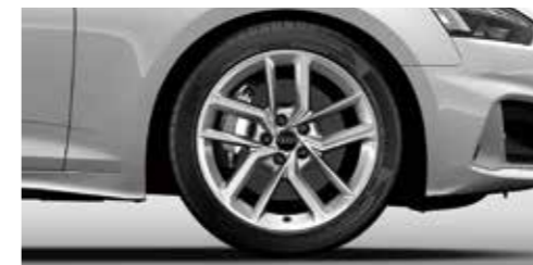
アルミホイール 5ダブルスポークデザイン 8.5]×18+245/40R18タイヤ [Audi A5 Sportback 35 TDI S line, A5 Sportback / A5 Coupé 40 TDI quattro S line, A5 Sportback / A5 Coupé 45 TFSI quattro S lineに標準装備]
