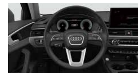
ステアリングホイール 3スポークレザー マルチファンクション パドルシフト
