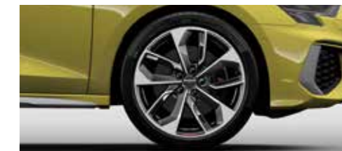
アルミホイール 5ダブルスポークエッジデザイン アンスラサイトブラック ダイヤモンドターン 8J×19 (Audi Sport)+235/35R19タイヤ [Audi S3 Sportback / S3 Sedanにオプション]
