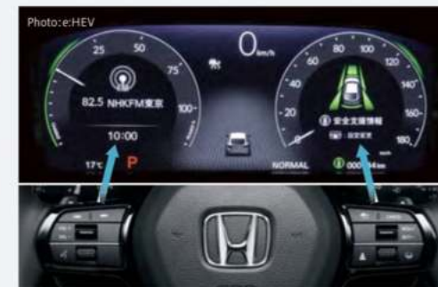
ステアリングスイッチと連動したレイアウトで、直感的な操作をサポートするデジタルグラフィックメーター。
