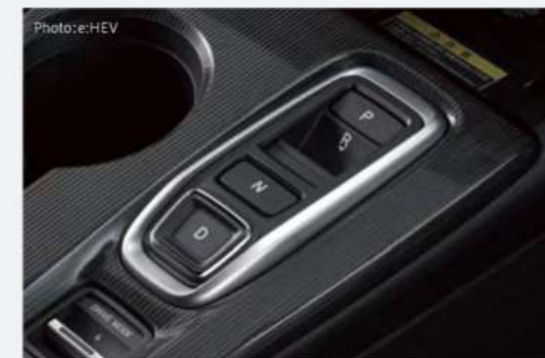
e:HEVモデルには、指先でスマートに操作できる、スイッチタイプのエレクトリックギアセクターを設定。
