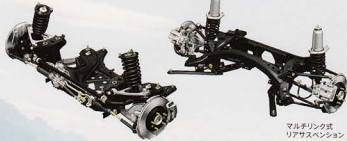
ダブルウィッシュボーン式フロントサスペンション マルチリンクリアサスペンション
