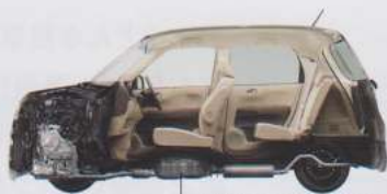
燃料タンクを前席下に収めた 「センタータンクレイアウト」 (特許技術) ■カットボディによる合成写真
