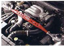
フロントストラットバー [全車に標準装備、SPIRIT Rシリーズはレッド塗装]
