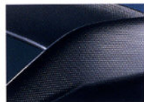
中空ワンピース構造のカーボンリアスポイラー
