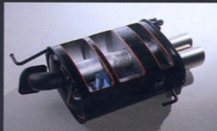
排圧感応型制御マフラー(カットモデル。撮影のため部分着色)
