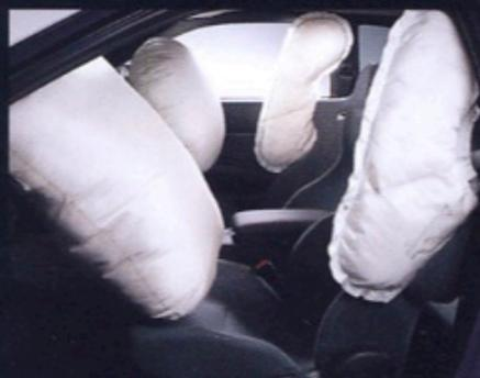
運転席・助手席SRSエアバッグシステム&運転席・助手席SRSサイドエアバッグシステム(メーカーオプション)
