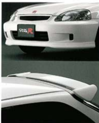
フロントアンダースポイラー(上) 大型リアスポイラー(下)
