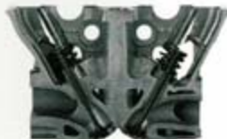
インレットバルブを軽量化し、さらにインレット、エキゾーストともに二重化バルブスプリングを採用。
