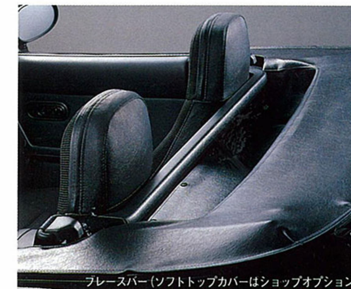
ブレースバー(ソフトトップカバーはショッポプション)
